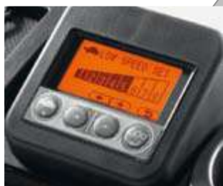
Fig. 2.9 Limitator de viteză motostivuitor Toyota TONERO
