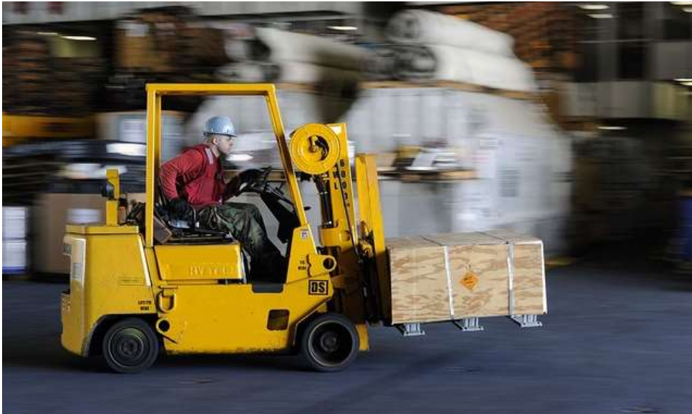
Fig. 7.21 Stivuitor cu sarcina poziționată corect
