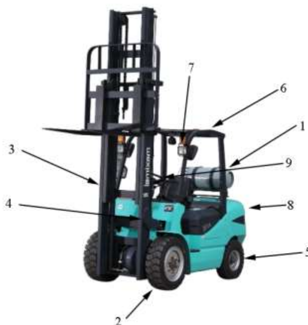
Fig 1.19: 1- butelia de GPL; 2- puntea motoare; 3-catargul; 4- cilindrii basculare catarg; 5- sistemul de direcție; 6-cabina stivuatoristului; 7 – sistemul de iluminat; 8- contragreutatea, 9-volanul.
