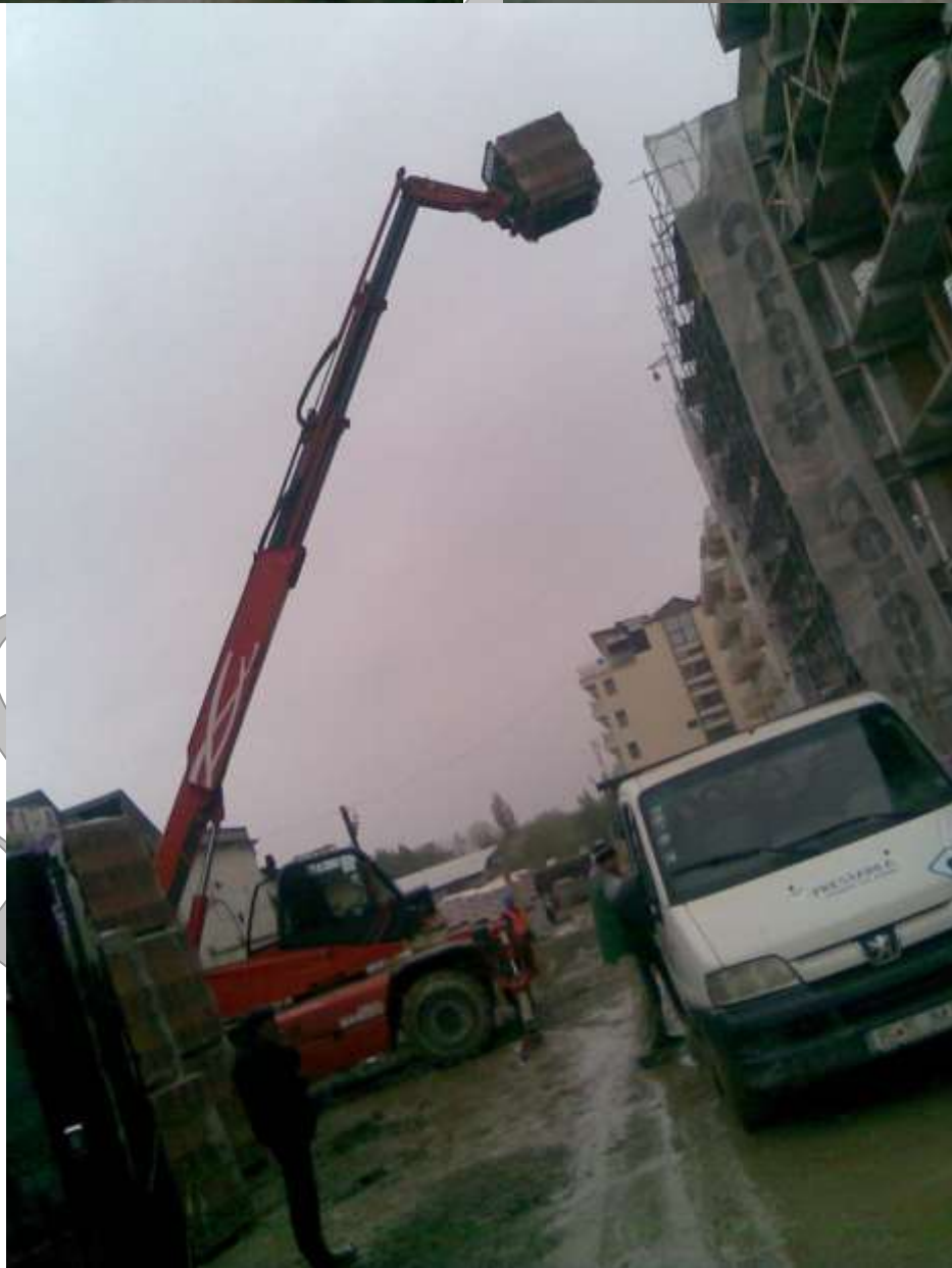
Fig. 1.14 Motostivuator cu braț telescopic
